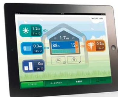
今回新たに開発した「D-HEMS II」では、前モデルとなる「D-HEMS」で行っていた蓄電池制御や、電力の使用状況の見える化、エネルギー情報履歴<sup>※11</sup>の確認に加え、水道やガスの使用状況や、部屋別・回路別の電力使用状況の把握が可能になりました。また、今回から新しい機能として、エアコンの自動制御を搭載し、「iPad」から一括して操作できるようになりました。
