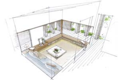
「Low LIVING」 ～ローリビング～低く住まう 基礎断熱により生まれた「掘り込み空間」のある心落ち着く空間デザインです。
