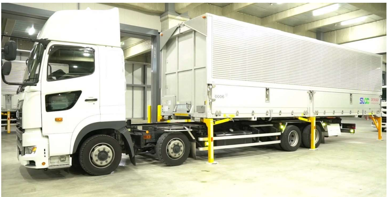
実証実験におけるスワップボディコンテナ交換の様子
