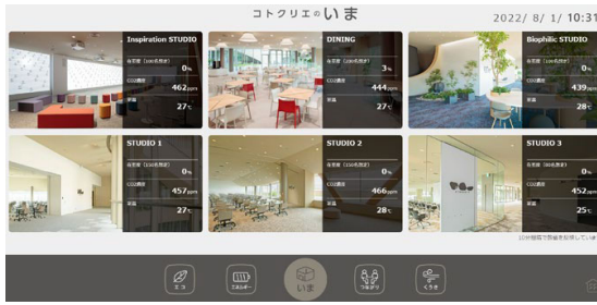
施設内の在室率・CO 2 濃度・室温を測定
