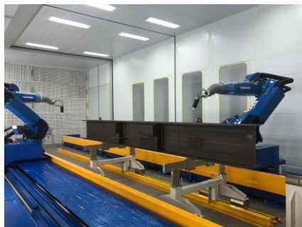
【建築梁塗装ロボット】
