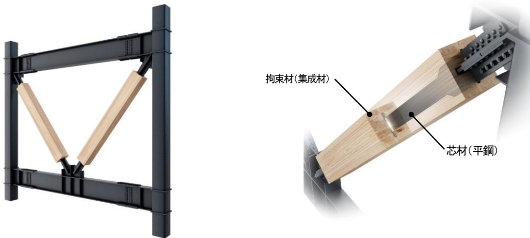
「木鋼ハイブリッドブレース」の構成
