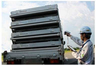
部材管理システムを利用し、品質・在庫管理を行う (左:整備検査時の様子、右:部材入出荷時の様子)
