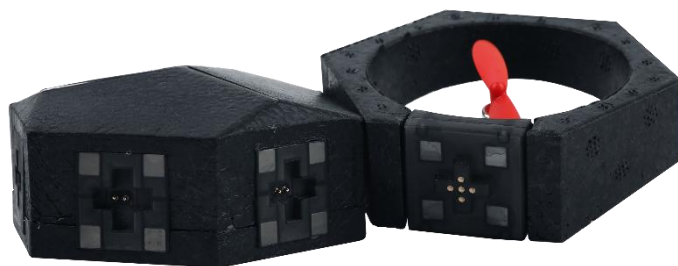
マグネットで結着しているプロペラは簡単に脱着が可能
