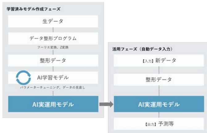
図のように、まず既存のデータやセンサデバイスで収集した時系列データを生データとして用意します。次に整形プログラム(フーリエ変換やZ変換)によって、AI用学習データである整形データに変換、その後パラメータのチューニングやデータの見直しをし、AI実運用モデルを完成させます。そして新しいデータを入力していくことで、正常異常判定や予測などの結果が得られるようになります。
