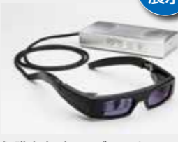
網膜走査型レーザアイウェア 視力やピント位置の影響を受け にくい投影方式
