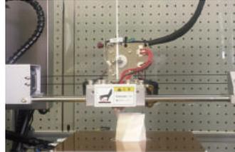
フィラメントを積み重ね立体物を造形する、熱溶解積層方式3Dプリンタ。
