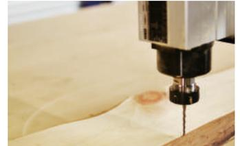
回転する刃物によって木材を切削加工する。
