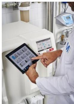
高純水製造装置の新製品「Elix<sup>®</sup>」は、メルクの従来製品と比べ純水供給量が最大1.5倍の1時間あたり150Lまで供給可能で、コンパクトながら1日1,800L(12時間稼働時)の製造能力を実現しました。純水を大量に必要とする大規模な研究室や製薬企業でも利用いただけます。また、3台までつなげて設置することができ、最大450L/時の製造が可能です。従来同様、メルク独自のロングライフEDI<sup>®</sup>(電気イオン交換)<sup>\*</sup>テクノロジーを搭載しているため、イオン交換樹脂の再生・交換が不要で、大電力も必要としないことから、低コスト・低メンテナンスでの純水製造が可能です。さらに、殺菌用UVランプを標準搭載しており、精製した純水の微生物汚染を防ぎます。
