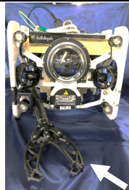
アームを取り付けた水中ドローン
