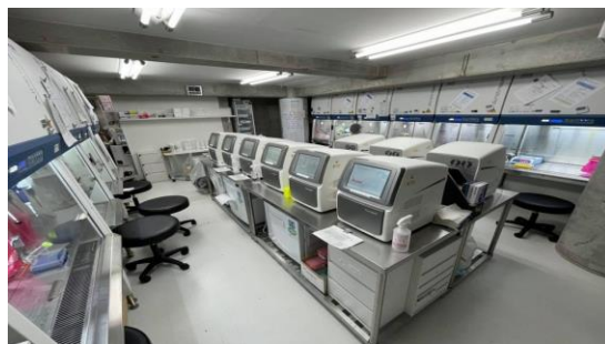
安全キャビネット及びクリーンベンチをPCR機の両側に配置
