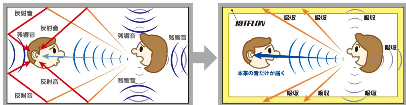
この材料はスタジオ、映画館、会議室などの不燃吸音壁として実際に多くの建築物に採用されているISTFLONの吸音壁システムを小型のパネルにした製品で、裏面にマグネットが付いていますので、スチールパーテーションなどのマグネットが付く面に誰でも簡単に取り付けることができます。マグネットが付かない石膏ボード下地の場合でも、ホッチキスで簡単に取り付けられる市販のフックやマグネット用金具による取り付けが可能です。
