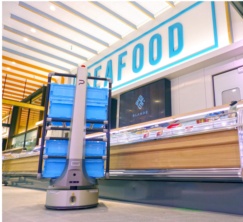
「BLANDE研究学園店」で実稼働する自律型協働ロボット『PEER』
