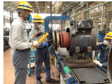
【主電動機整備作業】
