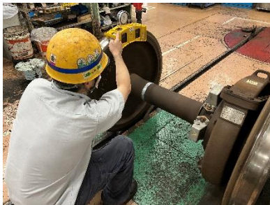
【輪軸検修作業】
