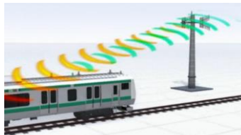
無線技術を用いた列車制御システム導入
