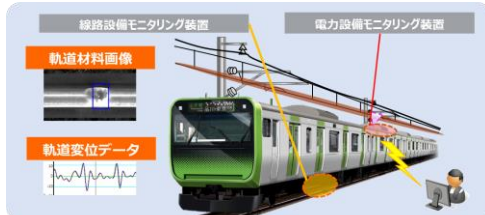
CBM（地上設備モニタリング）
