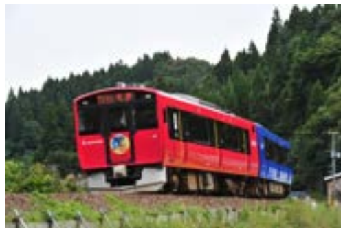
交流蓄電池電車 (EV-E801系)
