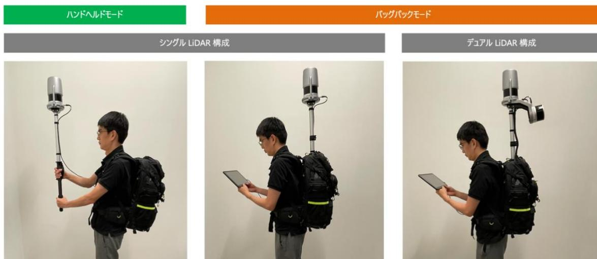
LIDAR取り付けポールは伸縮可能であり、使用しない場合はバックパックの中へ収納可能。
