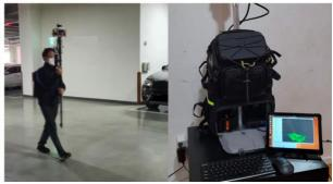
これらのマッピングキットを通じて、例えば、建設プロジェクトにおける進捗状況のモニタリングや検査のほか、林業におけるバイオマス(生物量)の推定、密度や成熟度、間伐計画オペレーションなどの森林分析等を用途として、屋内外の環境を簡単にスキャンすることができます。また、本マッピングキットはカスタマイズ可能で、GNSSや地上基準点を融合してジオリファレンス\*1した点群を生成したり、IMU データを利用してより優れた歪み補正を行い、鮮明な点群スキャンも実現することができます。GNSSが利用可能な地域と利用不可能な地域の両方で活動する顧客にとって、両方の環境で作業できることは、点群データにおけるドリフトやノイズのリスクの対処のために何度もマッピングを行う必要がないため、マッピング時間の大幅な短縮が期待できます。
