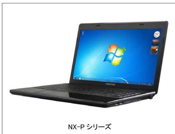
インターフェイスはHDMI出力、USB 2.0×3、Gigabit Ethernet、ExpressCard/34スロット、ミニD-Sub15ピン、マルチカードリーダー、S/PDIF兼用ヘッドフォン出力、マイク入力などを備えています。
