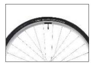
28Cと少し太めのタイヤを採用する ことで、乗り心地の良いクロモリフ レームを、更に乗り心地の良さを向 上させている
