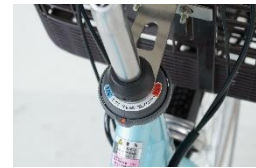
安定して荷物の載せ降ろしが可能なハンドルストッパー
