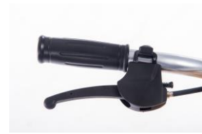
指挟みを防ぐガード付 ブレーキレバー※全車種に搭載
