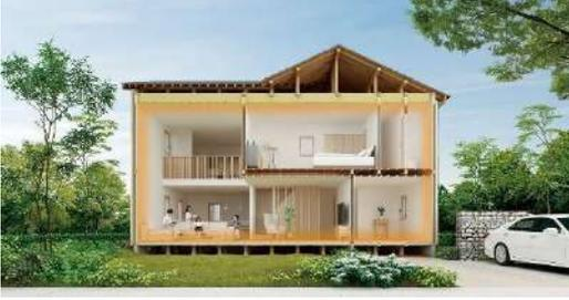
まるごと断熱リフォームは、今ある住まいを、一棟まるごと断熱改修することで高性能住宅化できる先進の工法。すぐれた性能の断熱材により、壁・天井・床をしっかり覆い、高断熱の窓や玄関ドアに交換。外気温の影響が少なく、快適・健康・省エネを実感できる暮らしを実現する。
