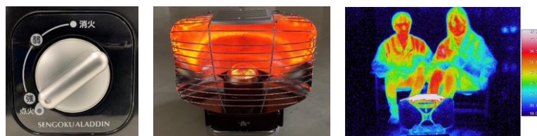
試験内容：室温17℃、100cm離れた場所から照射した5分後のサーモグラフィー
