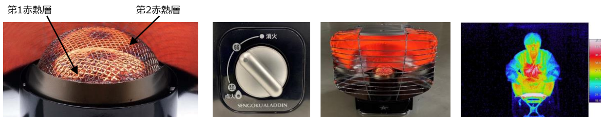
試験内容：室温17℃、50cm離れた場所から照射した5分後のサーモグラフィー
