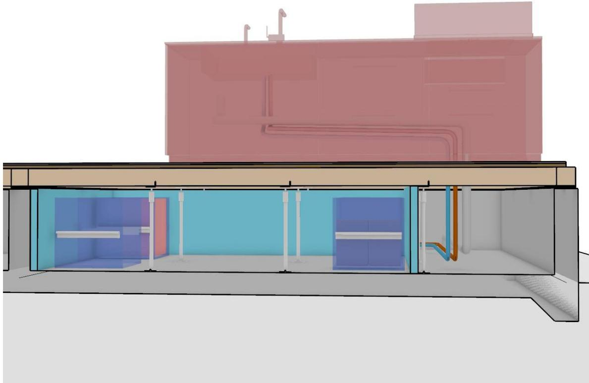
「ロボット床下収納」は、基礎の立ち上がり関係から、リビング・ダイニング・キッチンの床下を用いる。システムキッチン、通常の配管を用いると収納スペースを狭める可能性があることに留意する。一般の戸建て住宅では少ないと思われるが、横引き配管の採用も検討する。
