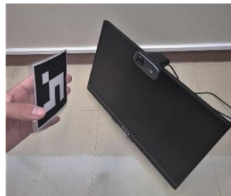
ARマーカー(左)の図形で ドローンを制御
