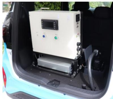
【通信装置・整流器（車両背面）】
