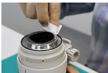
通信部清掃・点検
