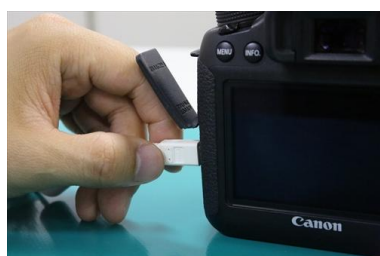
通信部清掃・点検
