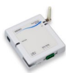
電力量モニタノード SW-4260-1120
