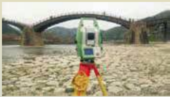
錦帯橋の3D計測
