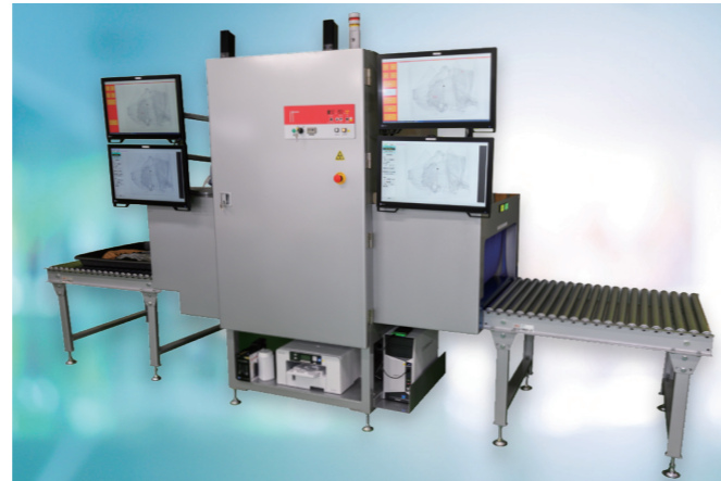
AI異物判定システム・X線検査機搭載型「ファッションドクター」
