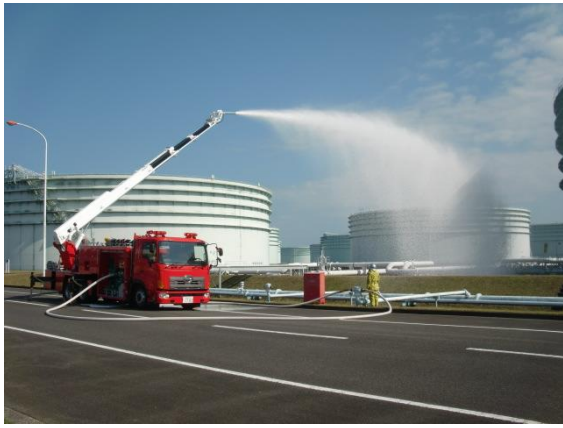
自衛防災組織(消防隊)の泡消火訓練 (昨年導入した最新の「大型化学高所放水車」を使って実施)
