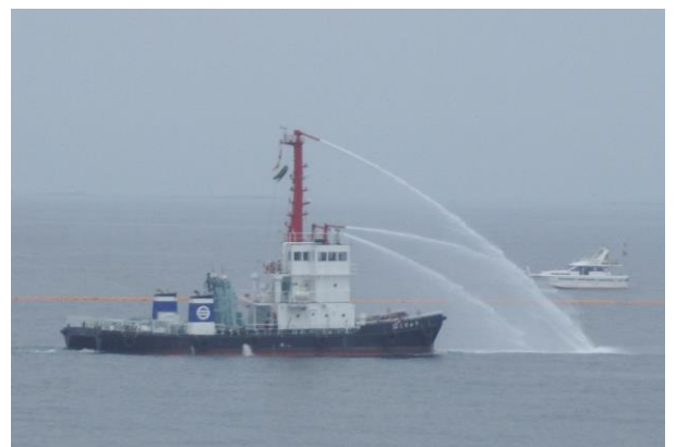
流出油防除訓練(放水・航走攪拌)
