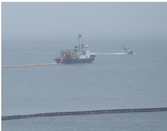
流出油防除訓練(オイルフェンスの展張)
