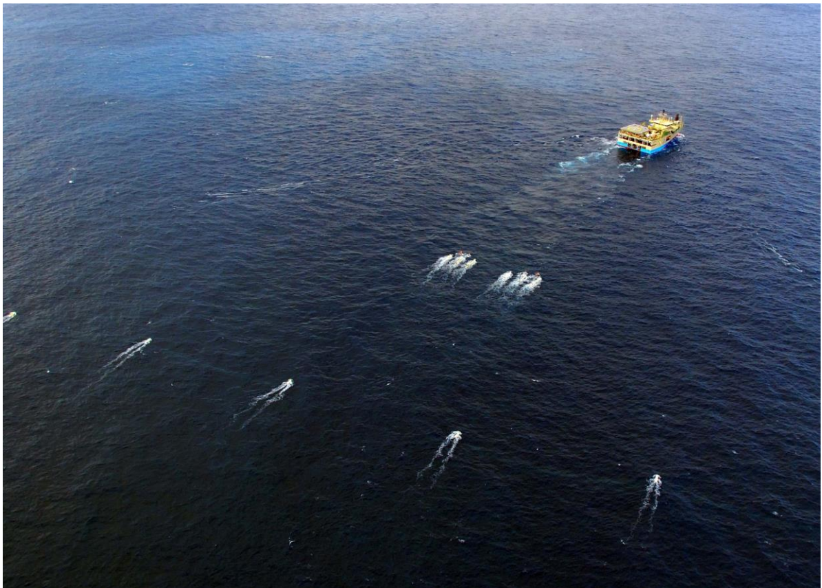
「資源」後方にエアガン、更に後方に展開されているストリーマーケーブル
