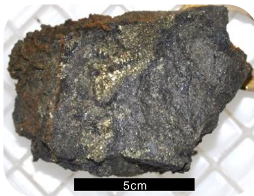
写真2 閃亜鉛鉱、黄銅鉱、黄鉄鉱からなる硫化鉱石 （品位分析結果は表の鉱石①）
