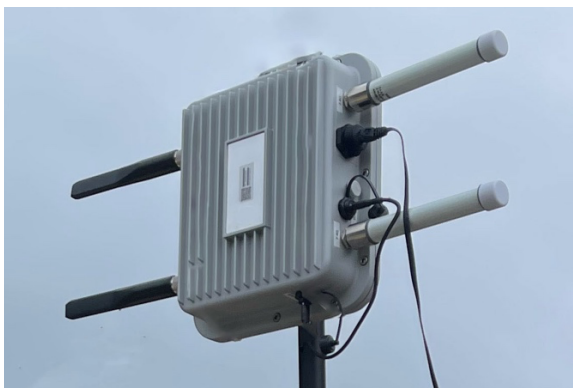
防水・防塵対応筐体にセットした BC-Link
