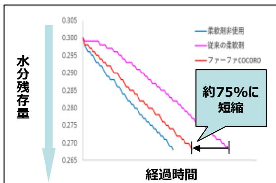
※試験布に水を滴下し、30秒毎に試験布の水分残存量を計測。
