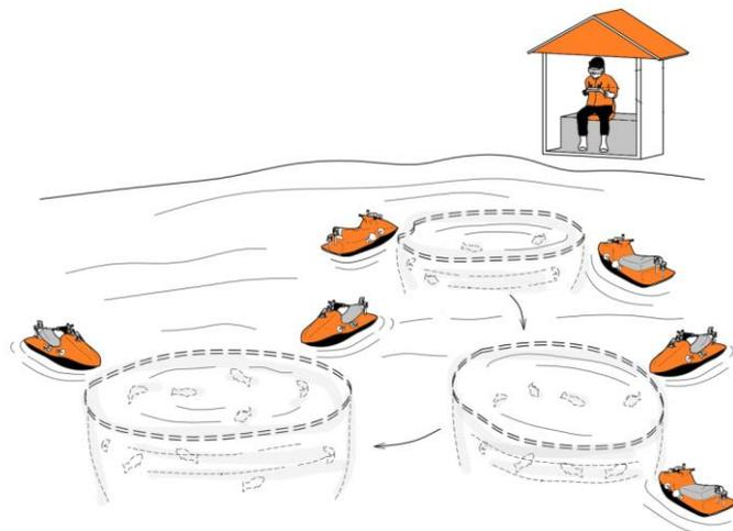
さらに、自動運転機能を組み合わせることで、マリンドローンの無人化が実現します。これにより、養殖プールの巡回やえさの補給、海上物流の自動化が可能となり、労働力の削減と業務の効率化が実現されます。悪天候時でも自動航行するため、物流の滞りを最小限に抑え、迅速なサービス提供が可能となります。
