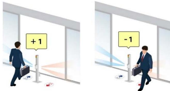
本体前面のセンサーが出入りする人を検知してカウントします。混雑状況を示す人数は 2 段階に設定でき、設定した人数を超えると LED 表示灯が緑色から黄色、赤色へと自動的に切り替わります。（人数が減ると自動的に赤色から黄色、緑色へと戻ります。）また、本体の背面にあるカウンターで施設内の滞在人数をリアルタイムに確認できます。
