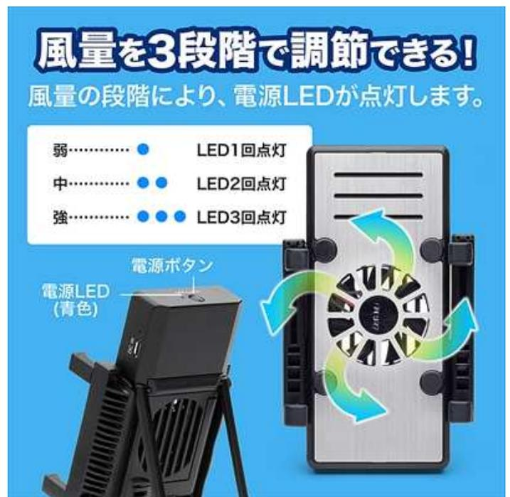
本製品は、7枚の羽根をもつ冷却ファンでスマホに風を当てて冷やすスマホ冷却クーラーです。長時間の使用や動画の視聴・撮影、バッテリーの劣化などが原因で熱くなるスマホの熱を逃がすことができます。容量1,000mAhのバッテリーを内蔵しており、充電しておけば電源不要で使用することができます。約1.5時間の満充電で約4時間分のファン回転が可能です。設置はスマホ本体を挟み込んで固定するタイプで、横幅53～95mm、厚さ15mm以下のスマホに対応しています。風量はLow（弱）、Mid（中）、Hi（強）の3段階で、スマホの状況にあわせて調整できます。背面に内蔵型の縦置き/横置き両対応のスタンド付きで、使用するアプリ等によって使い分けすることができます。サイドのホルダーは、ボタンとの干渉を防ぐ可動式です。スマホの接地面に放熱性の高いアルミ素材を使用しています。
