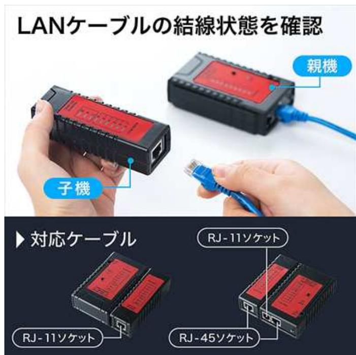
本製品は、LAN ケーブルの結線状態を確認できる LAN ケーブルテスターです。RJ-45 コネクタ付きの UTP、STP ケーブル や RJ-11 コネクタ 付きのモジュラーケーブルの結線状態を簡単に調べることができます。ケーブルの導通・断線・結線ミスやグラウンドの有無を確認することができ、ケーブルの結線状態は LED で表示されます。通常モードの場合は LED の表示スピードが速いので、ケーブルの状態を素早く確認する事ができます。LED 表示を遅くできるスローモード搭載で、LED の点灯スピードを遅くしてよりしっかりチェックする事ができます。親機と子機(リモートユニット)は分離できるので LAN 配線工事後の敷設済みのケーブルも簡単に確認できます。LED ライト内蔵で、暗所での作業にも便利です。
