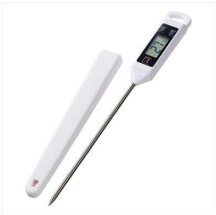
本製品は中心温度センサーで対象物に接触して温度を測定できるスティック型温度計です。測定範囲は-50℃～330℃で、0.1℃刻みで細かく測定可能です。調理中の肉や魚などの焼け具合の確認、お風呂の温度や土壌などの温度確認など、表面温度計ではわからない温度を測ることができます。IP54 の防水規格の生活防水に対応しており水場での使用も可能です。測定方法は対象物にセンサーを差し込み、約 20 秒待つと中心温度の計測を完了します。センサーは、長さ約 14.5cm あり厚みのあるものや深いものでも測定しやすくなっています。温度表示は大きめの文字サイズの液晶式を採用し、温度をひと目で確認することができます。使用ボタンも「ON/OFF ボタン」、一時的に表示を固定できる「HOLD ボタン」、摂氏と華氏の切り替えができる「℃/° F ボタン」の 3 つで、シンプルな設計です。オートパワーオフ機能付きで、15 分使用しない際、自動的に電源を切ってくれるので、電源の切り忘れがありません。
