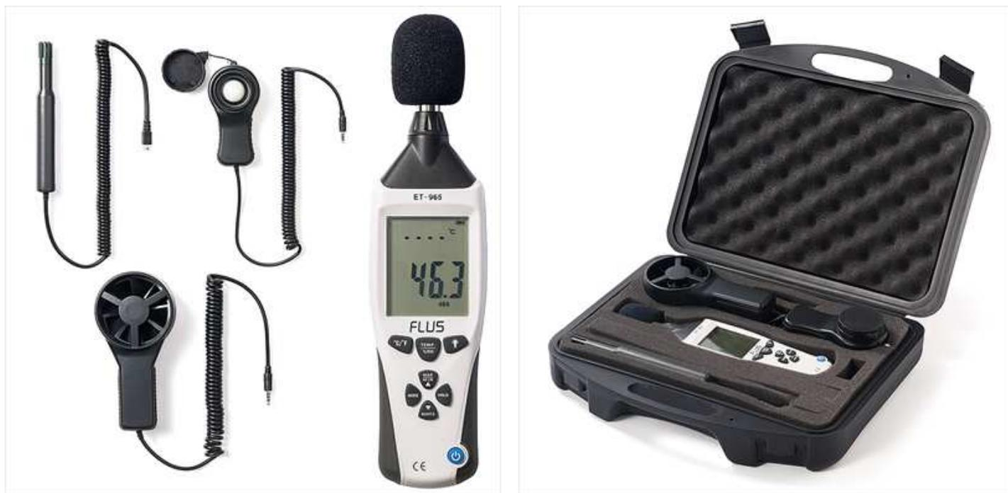
本製品は騒音や風速から照度、温度、湿度まで、1台で5項目の測定が可能な1台5役のマルチ測定器です。各種測定にはアタッチメントを取り付けての測定で、計測したい内容によって切り替えることができます。騒音計としては、そのまま使用でき35dB～130dBの範囲で、騒音を測定できます。風速測定器としては、風速センサーを取り付け0.5m/s～30m/sの範囲で測定できます。屋外イベント、スポーツ大会、ゴルフなどに活用できます。照度センサーを付ければ、0～200K Luxの広い範囲で測定できます。図書館、美術館、工場など多くの場所での環境照度測定に使用できます。温度・湿度センサーを付ければ、住居、事務所、学校環境等の温度・湿度測定に使用できます。温度-40℃～70℃、湿度10%～95%RHの範囲の測定が可能です。
