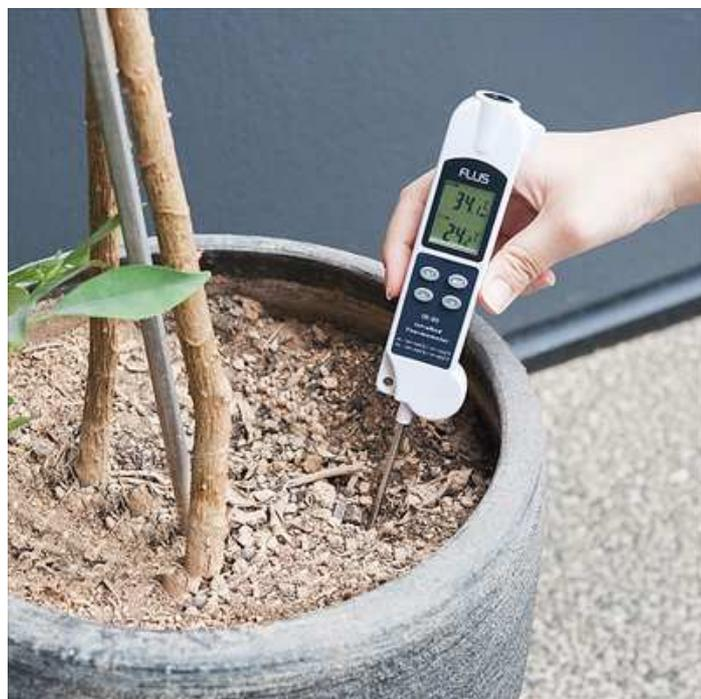
本製品は、表面温度を計測できる赤外線放射温度測定と、中心温度が計測できる接触測定が可能な測定器です。放射赤外線センサーで対象物に触れることなく-35℃～330℃の幅広い温度測定が可能です。対象物に触れないので、衛生的で安全で高い場所の測定にも使用できます。中心温度センサーで対象物に接触して-20℃～260℃の温度測定が可能で、食品や料理の測定に便利です。接触測定で、料理での火の通り具合や水温測定などにも使用できます。液晶ディスプレイは、上部に非接触温度、下部に接触温度を表示可能です。対象物の素材に合わせて、放射率を0.1～1.0の範囲で調整できます。対象物の性質に応じて放射率を調整することで、より正確に測定できます。ボタンを押さずに常時測定できる「LOCKモード」に設定すると、ボタンを押すことなくかざすだけで温度を常時測定できます。
