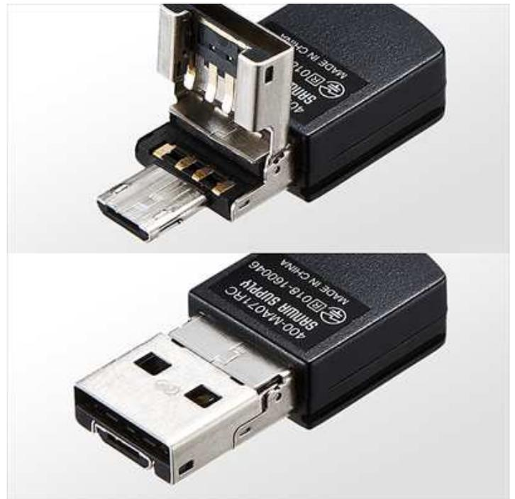
本製品は、レシーバーが2種類のコネクタに対応したワイヤレスブルーLED センサーマウスです。一般的なマウスは、USB A コネクタかmicroUSB コネクタのどちらかでしか接続できないものが多いですが、本製品はパソコンと接続する際にはUSB A コネクタ、スマホやタブレットと接続するにはmicroUSB コネクタを使い分けて接続することが出来ます。レシーバーのコネクタ部分が跳ね上げ式になっており、接続する機器に合わせて変換する事が出来ます。レシーバーが変換コネクタと一体型なので、アダプタの紛失の心配がなく、収納場所にも困りません。マウスの筐体は長時間使用しても疲れにくいエルゴノミクス形状です。マウスの持ち手の下には出っ張りがあるので親指と机との摩擦から保護します。マウスのセンサーは読み取り精度の高いブルーLED センサーを採用しています。WEB の閲覧や操作を快適にする3つの追加ボタン (進む・戻る・Windows ボタン) を持っています。また、持ち運びに便利な携帯用ポーチ付きで、マウス本体を傷から守ります。また、レシーバー収納ポケットも付いているので紛失の心配がありません。
