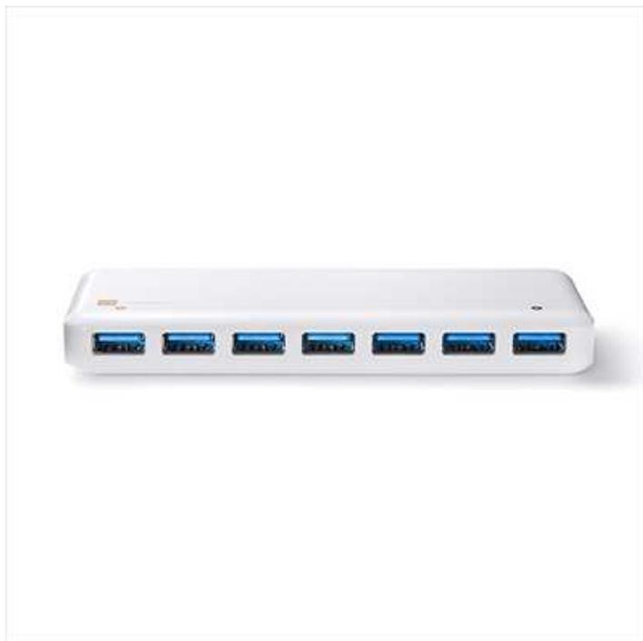
本製品は、最大7種のUSB機器を接続できる7ポートのUSB3.0ハブです。7ポート全てUSB3.0に対応しているので最高5Gbpsの高速伝送速度を実現しています。また、充電に最適な最大2A出力可能なポートを2ポート搭載しており、マウスやカードリーダー等を接続しさらに通常のUSB通信に加え、スマートフォンの急速充電、タブレットの充電が可能です。（※充電用2ポート合計2Aまで、7ポート合計最大4.8Aまで出力可能です。）24W（DC12V/2A）出力可能なACアダプターを付属しており、消費電力が多いハードディスク等でも安定した動作が可能です。また接続機器の数や使用環境によってはバスパワーで使用することもできます。
