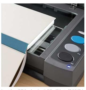
本製品は、本を裁断せずにスキャンできるブックスキャナーです。一般的なスキャナーはガラス面までの幅が分厚く、文字が切れたり本の中央に影が出来たりすることがあります。しかし、本のスキャニングに特化した設計で、ガラス面までの間のエッジが約6mmなので、綴じしろの影が映らず、ページの端まで綺麗にスキャン出来ます。片面ずつスキャンすれば、本を裁断せずに非破壊自炊することが出来ます。
