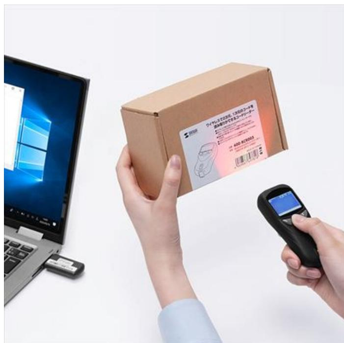
本製品は、Bluetooth接続で、ワイヤレスで使用できる2次元コード対応の、バーコードリーダーです。JANコードなどの1次元コード、QRコードなどの2次元コードのどちらのコードも読み取りできます。パソコンやスマートフォンの画面に表示されたコードも読み取りできます。高さ約1.2mからの落下衝撃にも耐えられる耐衝撃性能を備えているので、安心して使用できます。付属の設定コード一覧で、音の設定や区切り文字の変更などができます。USB充電のバッテリー内蔵で、満充電時のスキャン動作目安は、約10000回です。落下を防止する、ストラップを付属しています。
